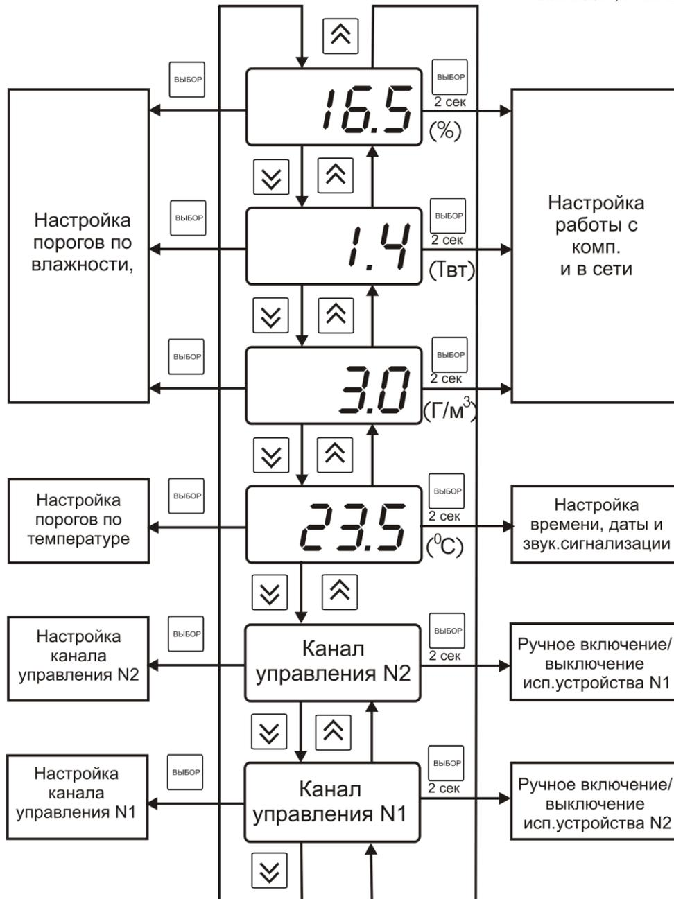
Рисунок 6.1 (б) Режимы РАБОТА и НАСТРОЙКА
