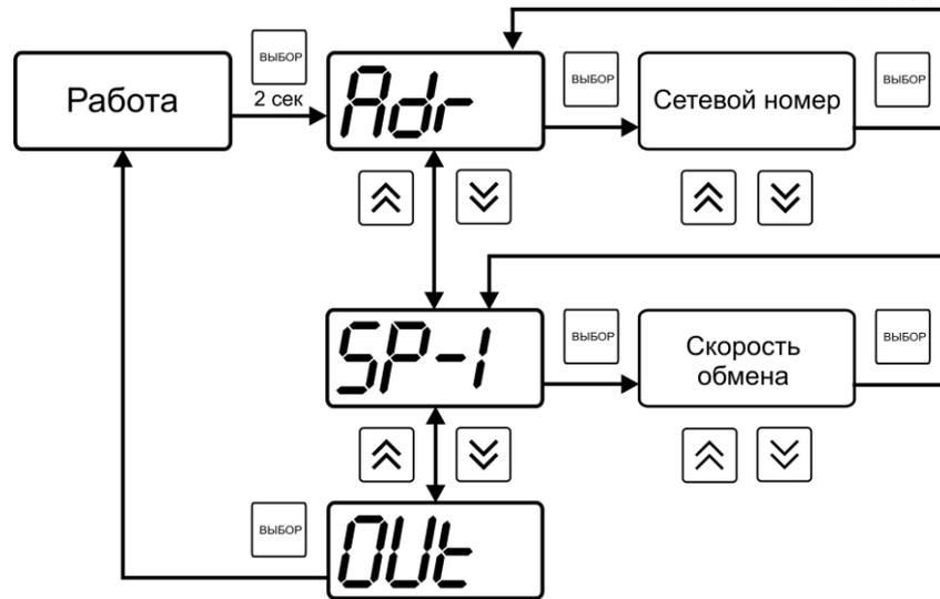
Рисунок 6.10 Меню установки параметров прибора для работы в сети
