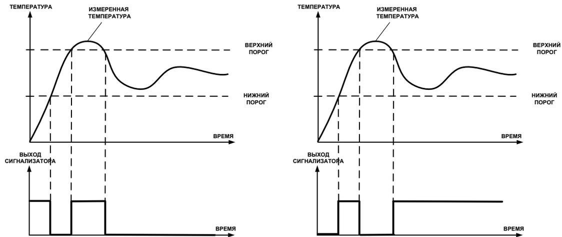
Рисунок 3.10 Функция вида  $f = \text{НП} + \text{ВП}$ , слева – сигнализация выхода измеряемого параметра за диапазон, справа – тоже с инверсией, сигнализация, что измеряемый параметр находится в диапазоне
