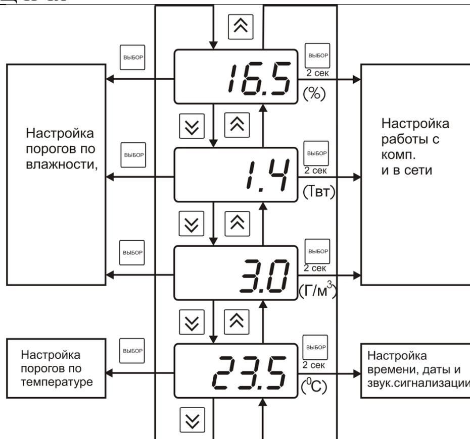
Рисунок 6.1 (а) Режимы РАБОТА и НАСТРОЙКА для исполнения ИВТМ-7 /1-Щ
