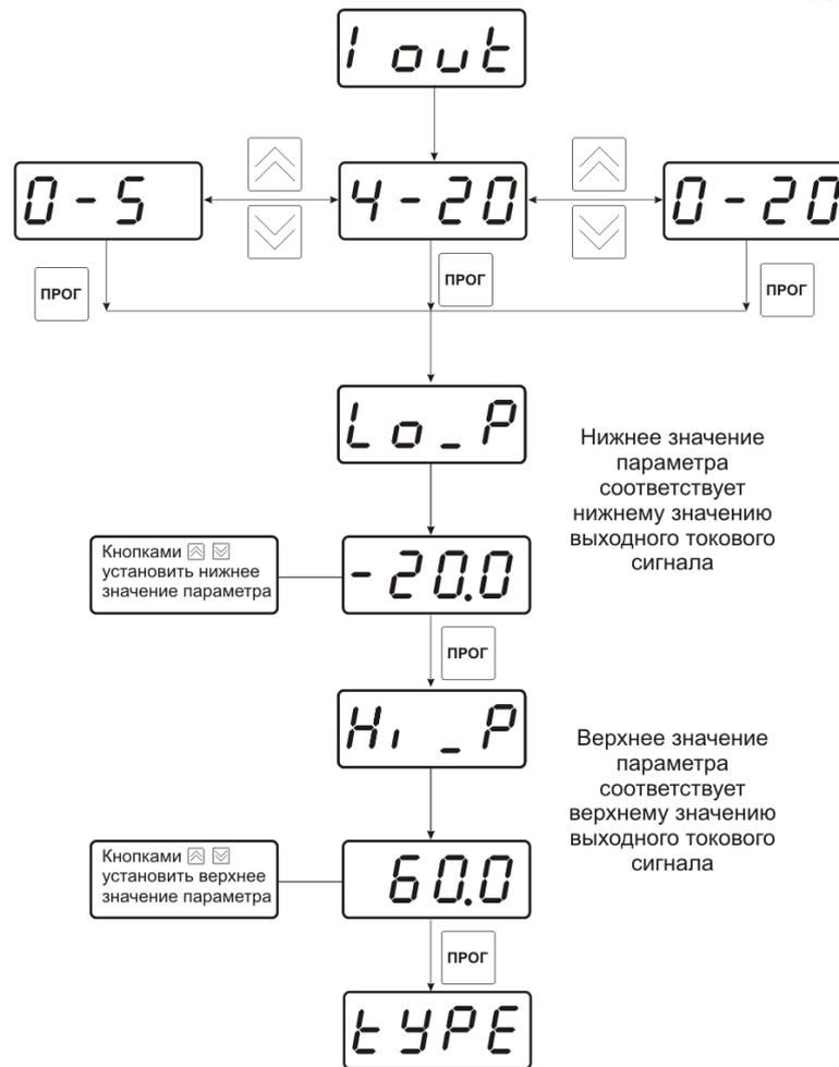
Рисунок 6.6 Настройка линейного токового выхода
