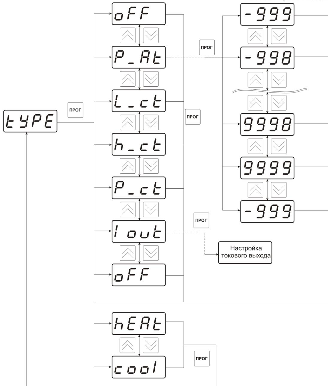
Рисунок 6.4 Логика и тип работы исполнительных устройств
