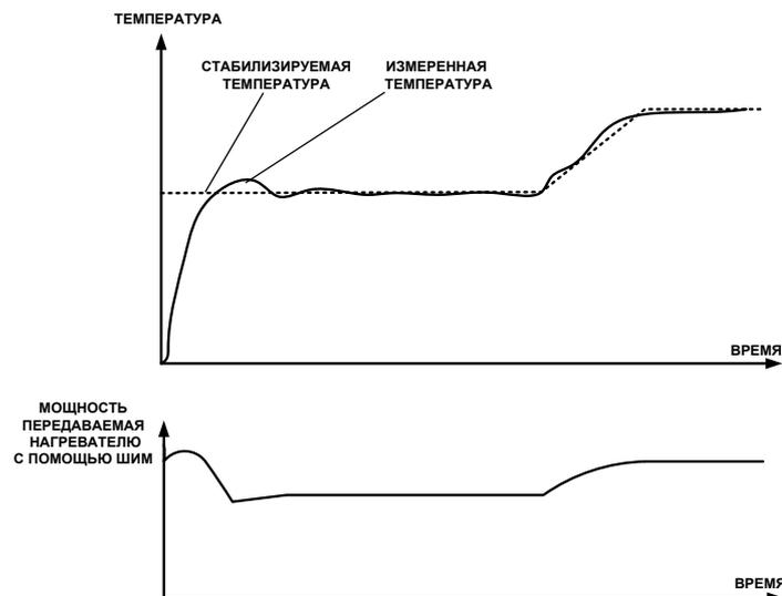
Рисунок 3.12 Стабилизация по ПИД закону (нагреватель)
