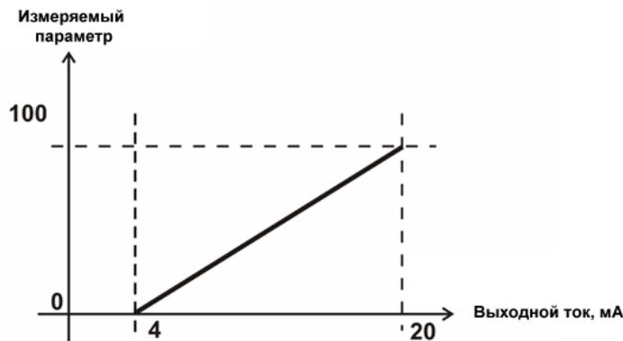
Рисунок 3.14 Линейный выход 4...20 мА по параметру от 0 до 100
