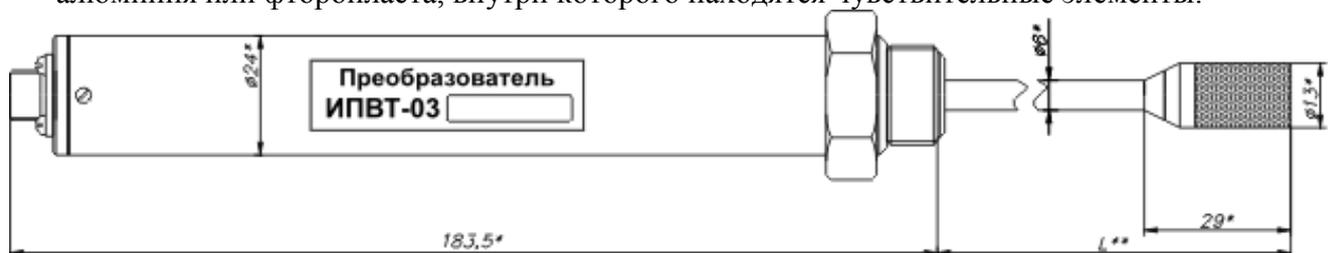
Рисунок Б5 Измерительный преобразователь ИПВТ-03-06-ПВ(-ПС)
