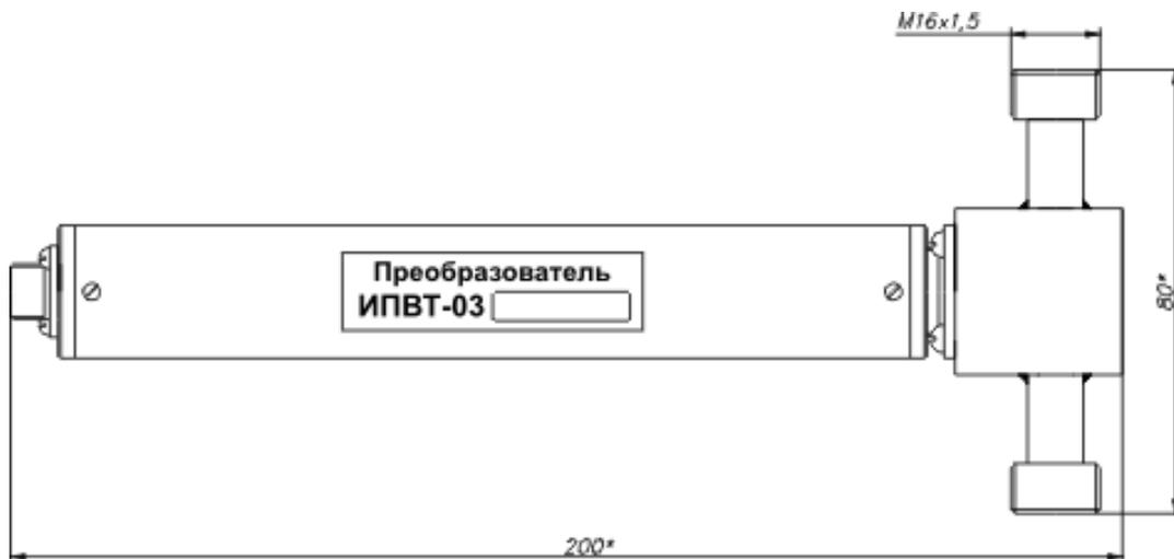
Рисунок Б2 Измерительный преобразователь ИПВТ-03-03-ПВ(-ПС)
