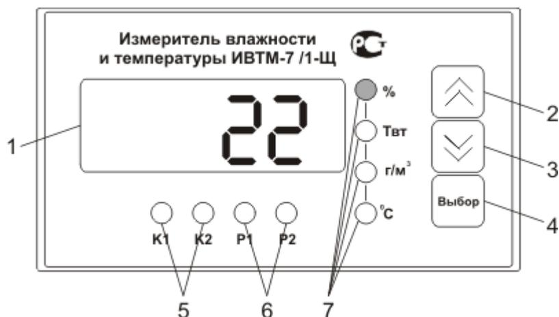
Рисунок 3.1 Вид передней панели прибора
