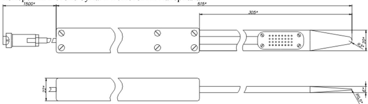
Рисунок Б7 Измерительный преобразователь ИПВТ-03-11-ПВ
