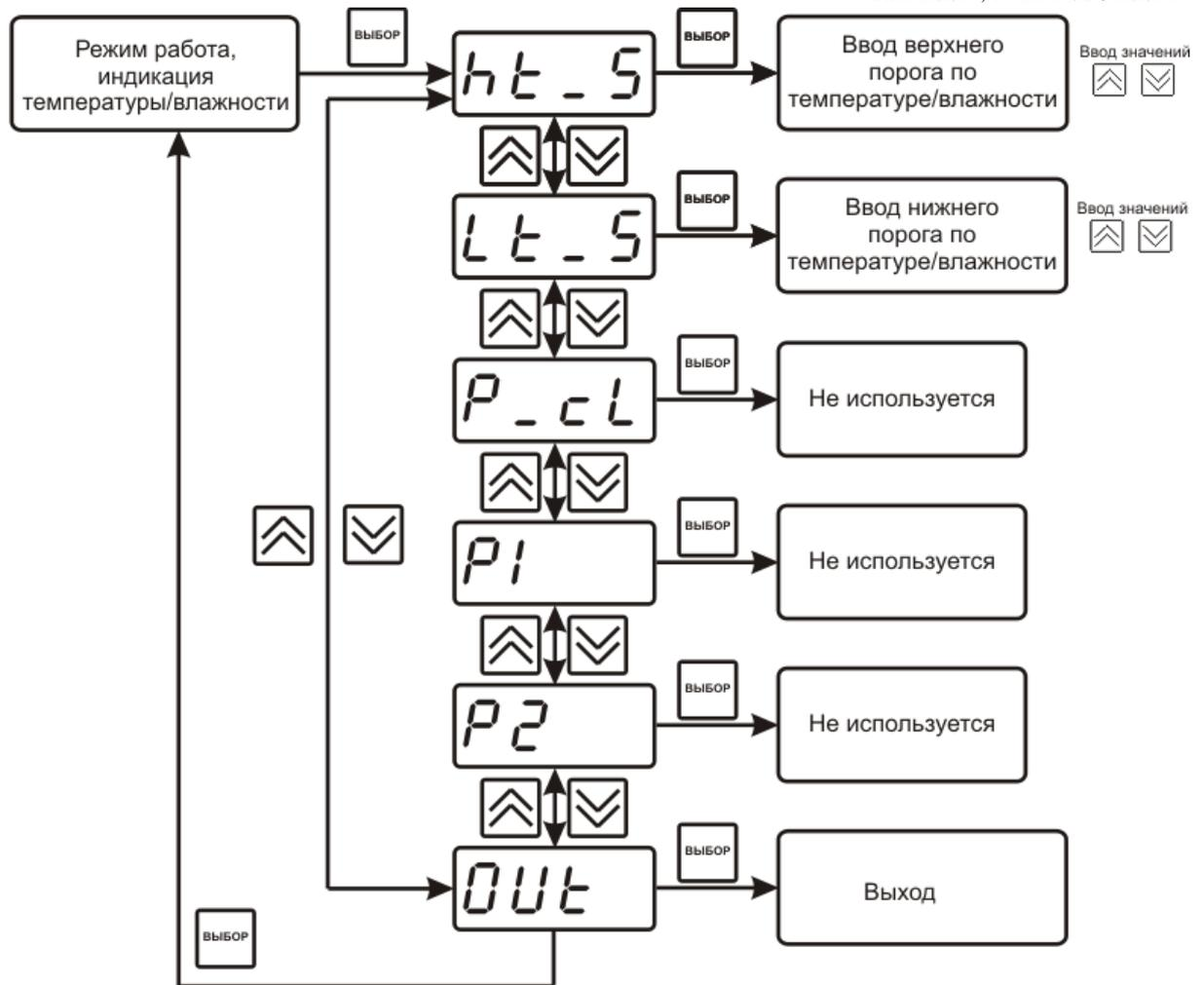
Рисунок 6.3 Схема задания порогов по температуре (влажности)
