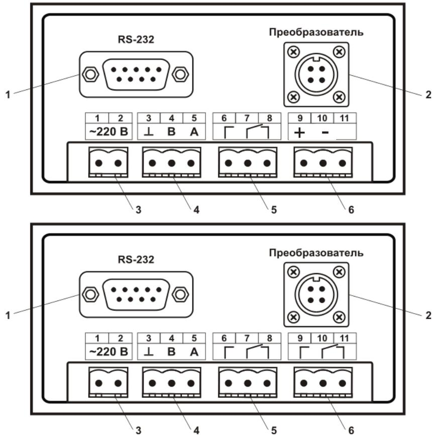
Рисунок 3.2 Задняя панель прибора (в исполнениях ИВТМ-7 /1-Щ, ИВТМ-7 /1-Щ-2А, ИВТМ-7 /1-Щ-1Р-1А, ИВТМ-7 /1-Щ-2Р (сверху вниз))
