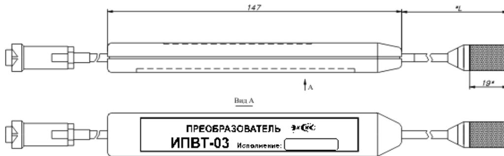
Рисунок Б1 Измерительные преобразователи ИПВТ-03-01-ПВ(-ПС),
