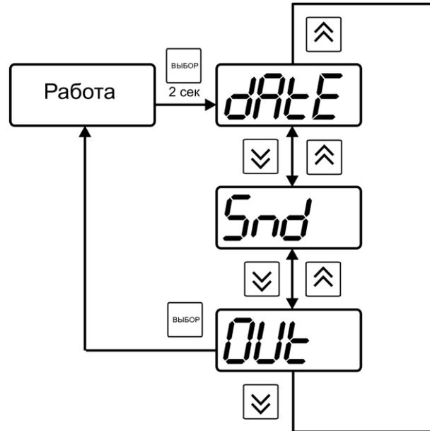
Рисунок 6.11 Меню установки даты и звуковой сигнализации
