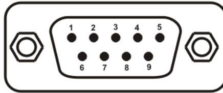
Рисунок 3.4 Разъем подключения прибора к компьютеру по RS-232
