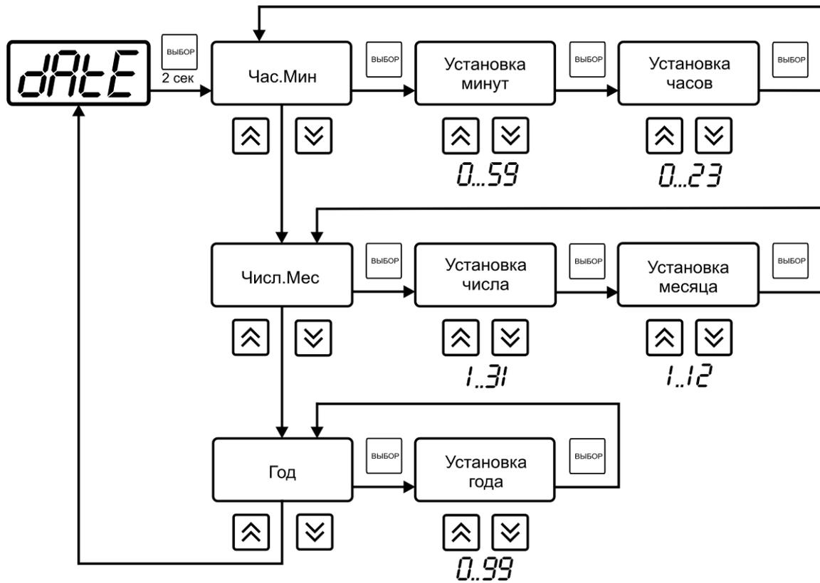
Рисунок 6.12 Настройка установки времени и даты
