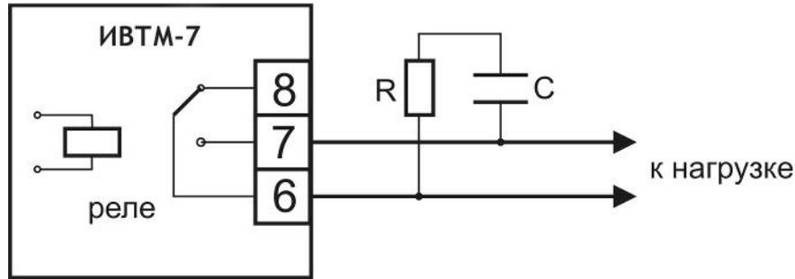
Рисунок 3.13 Подключение нагрузки к релейному выходу
