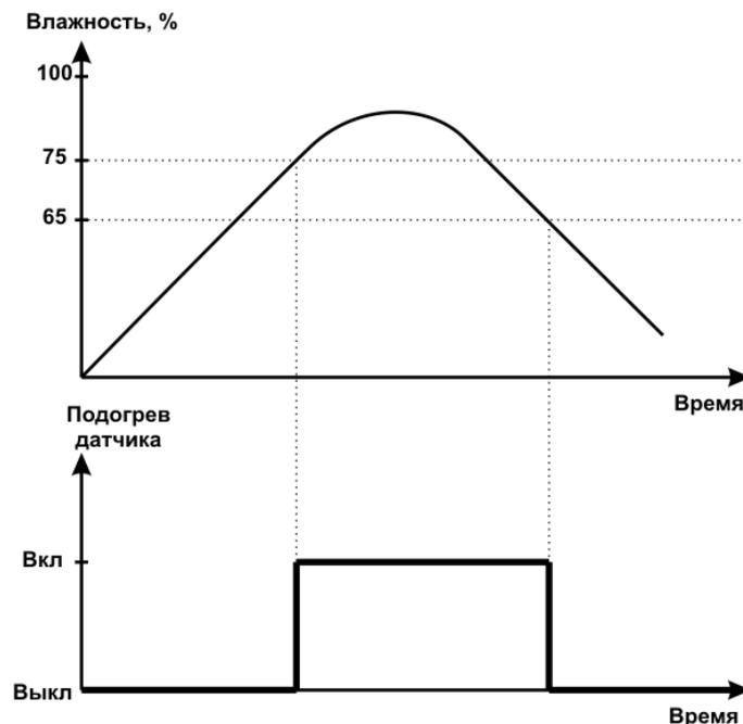
Рисунок 3.15 Работа подогрева сенсора влажности в измерительном преобразователе.
